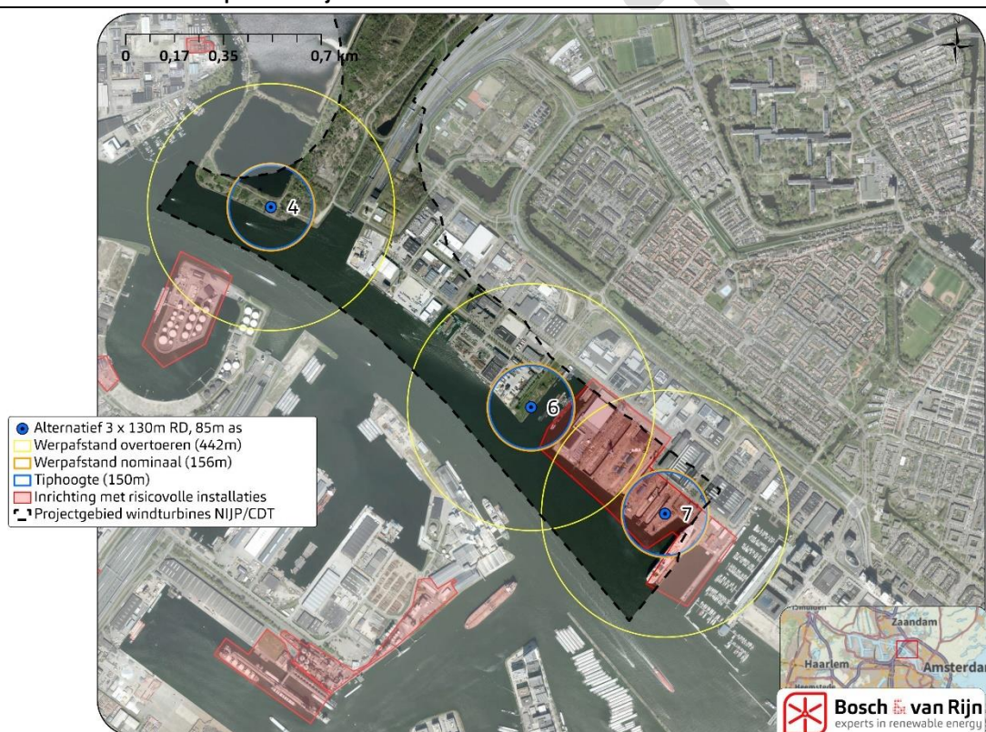
Figuur 8 Maximale werpafstand bij overtoeren van de windturbines en risicovolle installaties.
