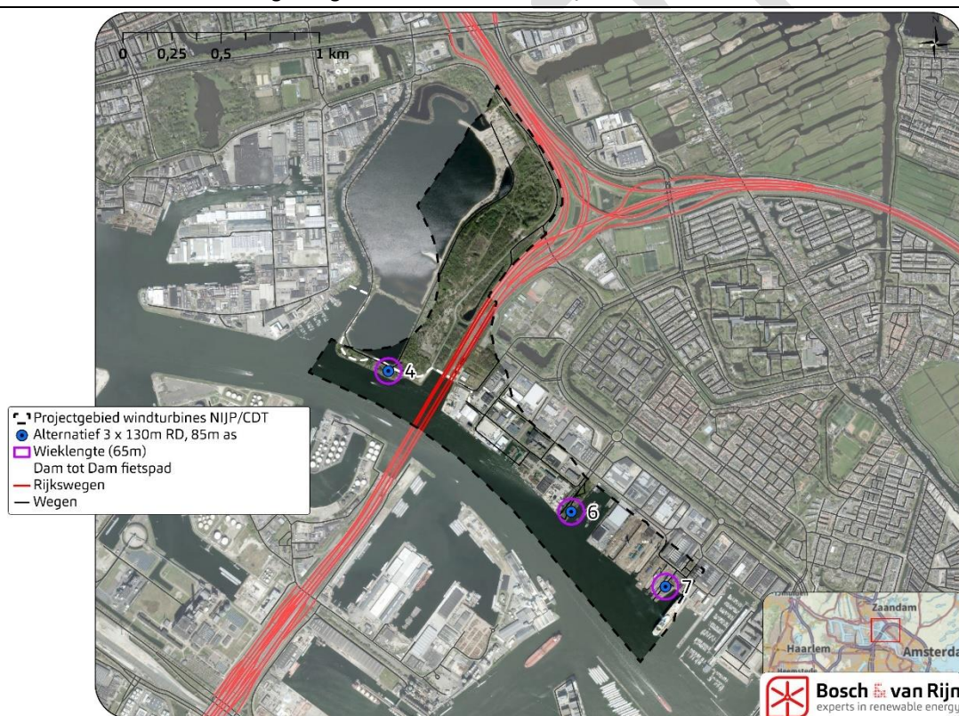
Figuur 17 Overdraai boven wegen in geval van alternatief 3x 130/85
