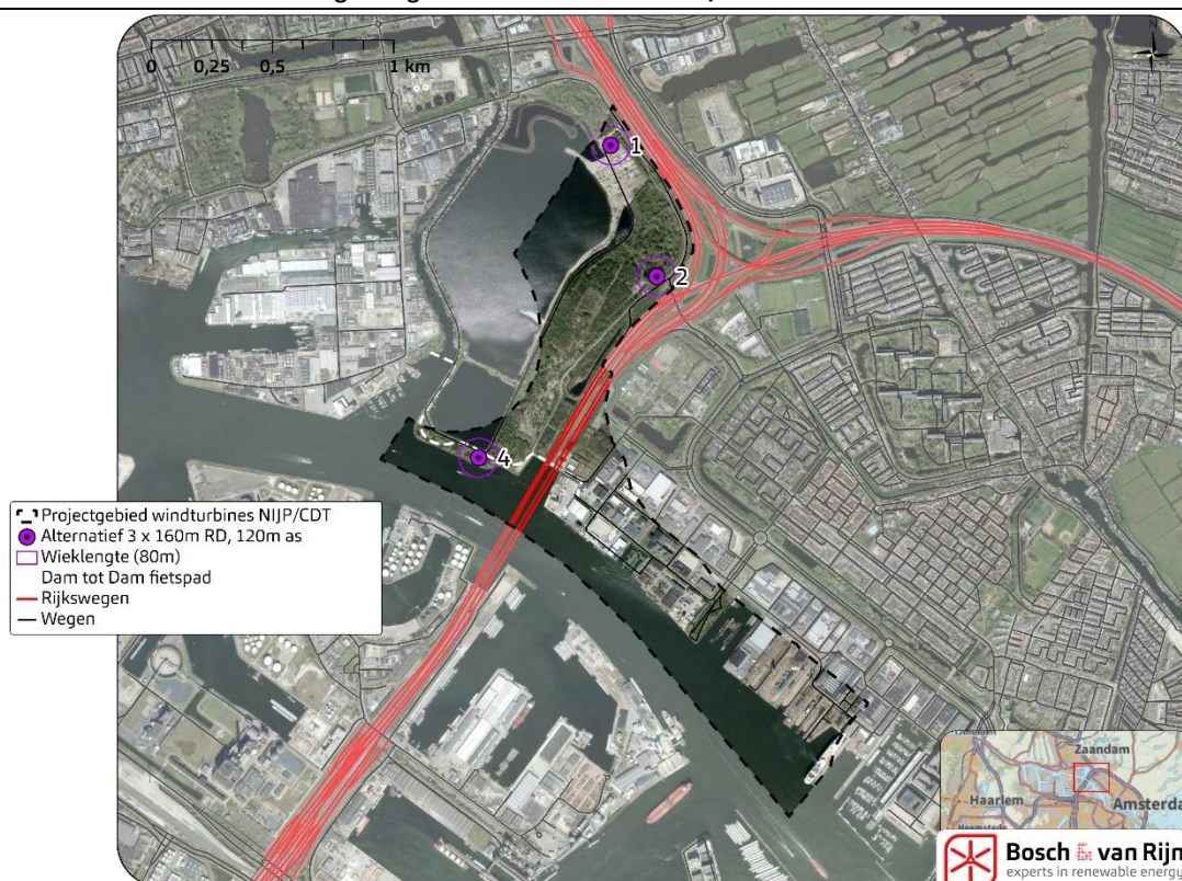
Figuur 18 Overdraai boven wegen in geval van alternatief 3x 160/120
