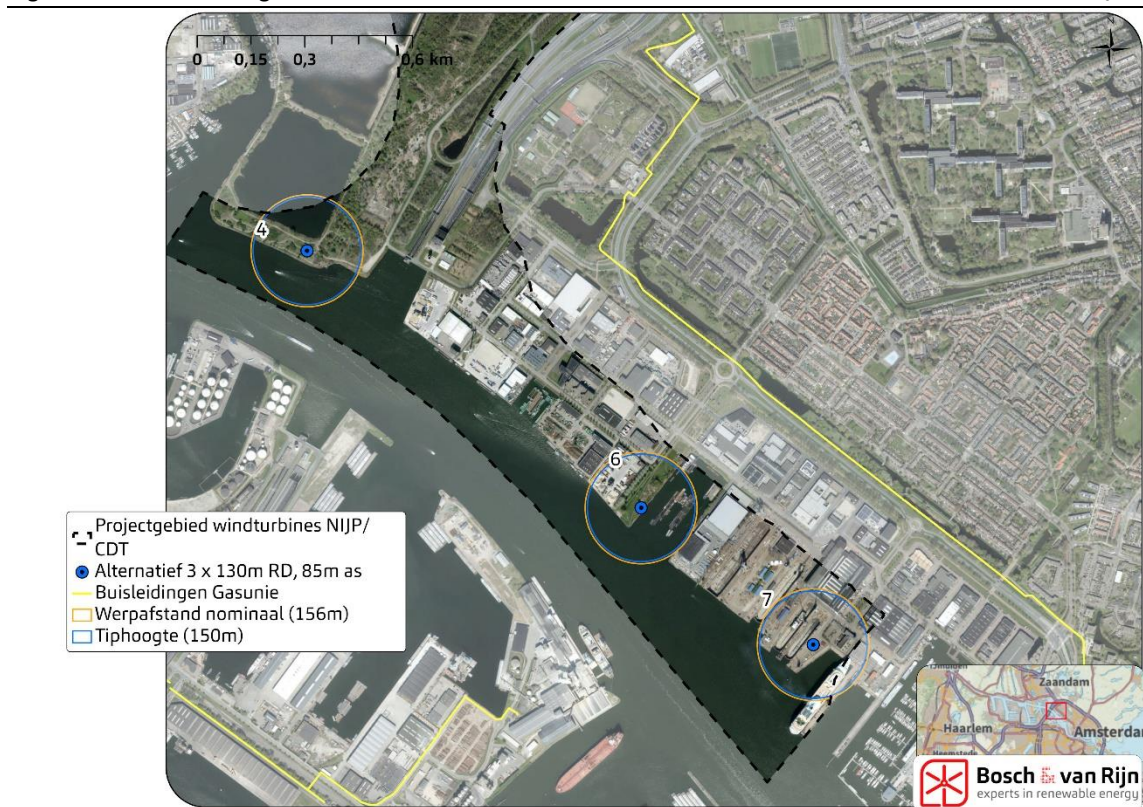
Figuur 11 Buisleidingen Gasunie en adviesafstanden rondom de windturbines van MER-alternatief 3x130/85
