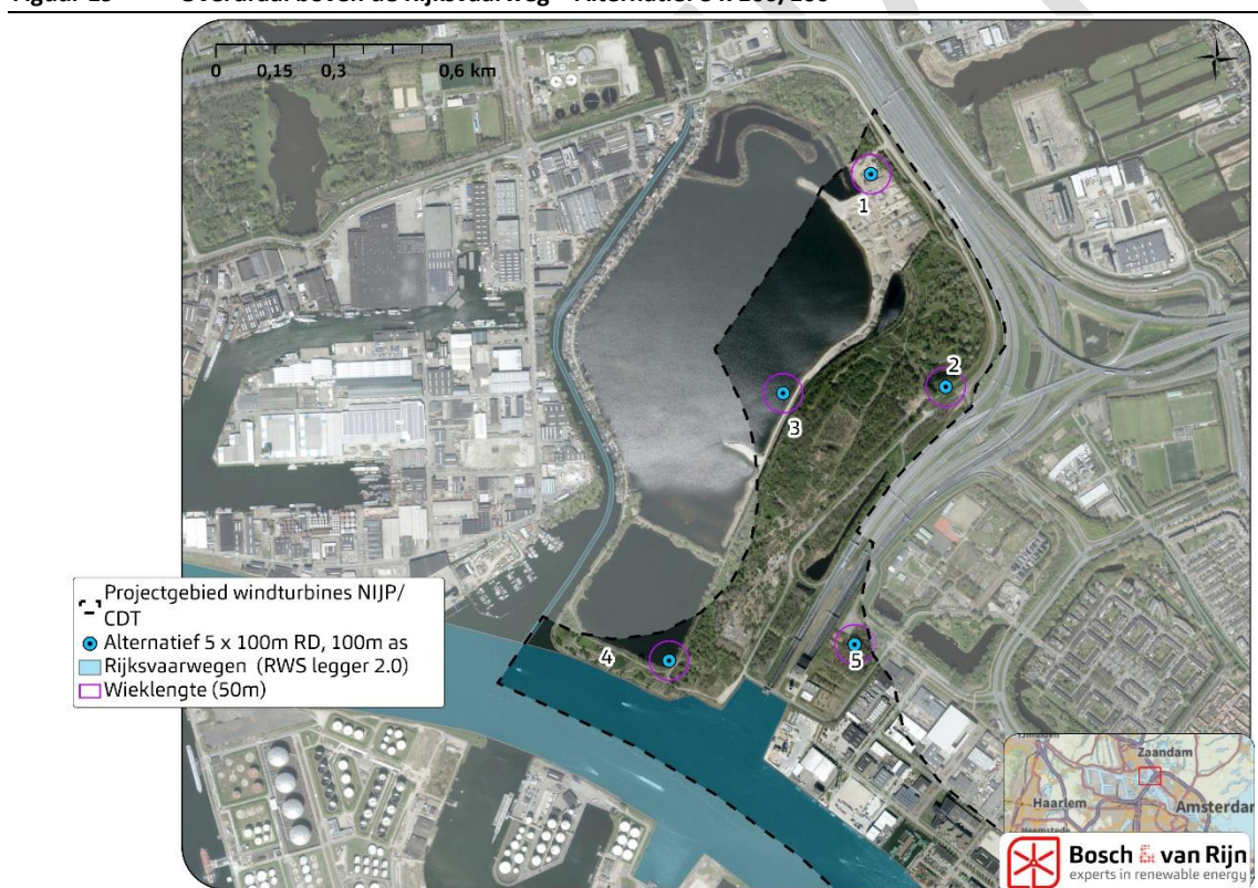
Figuur 19 Overdraai boven de Rijksvaarweg – Alternatief 5 x 100/100
