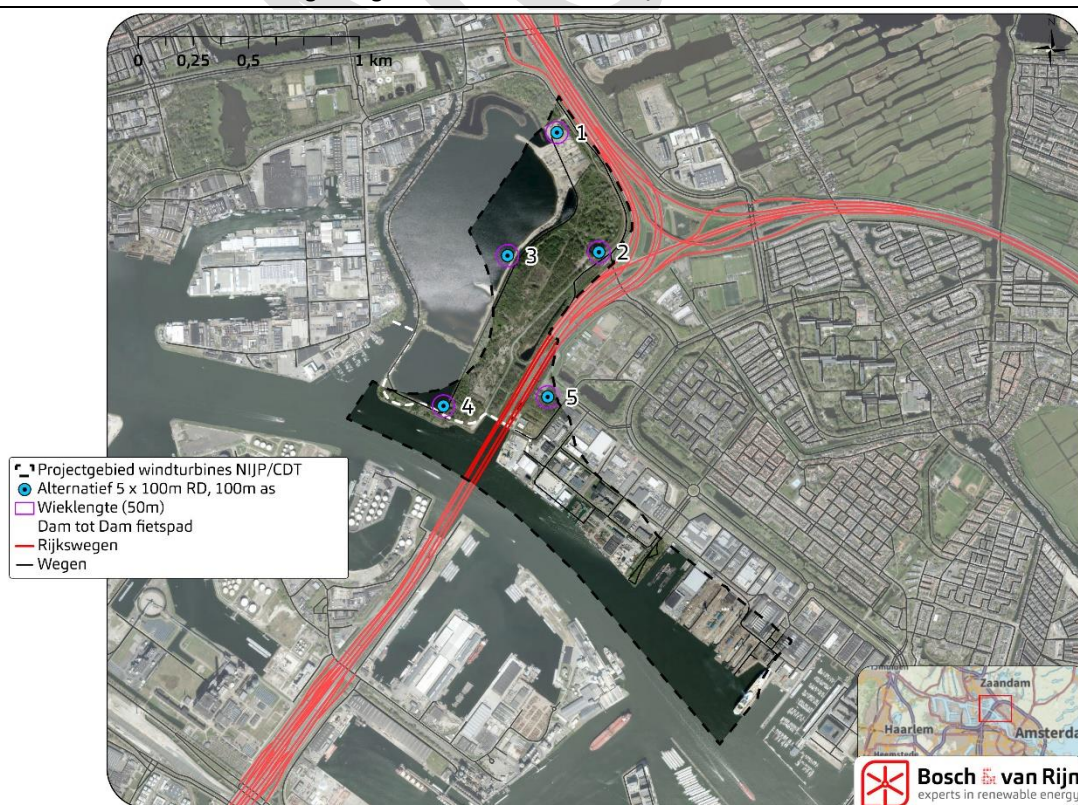
Figuur 16 Overdraai boven wegen in geval van alternatief 5x 100/100
