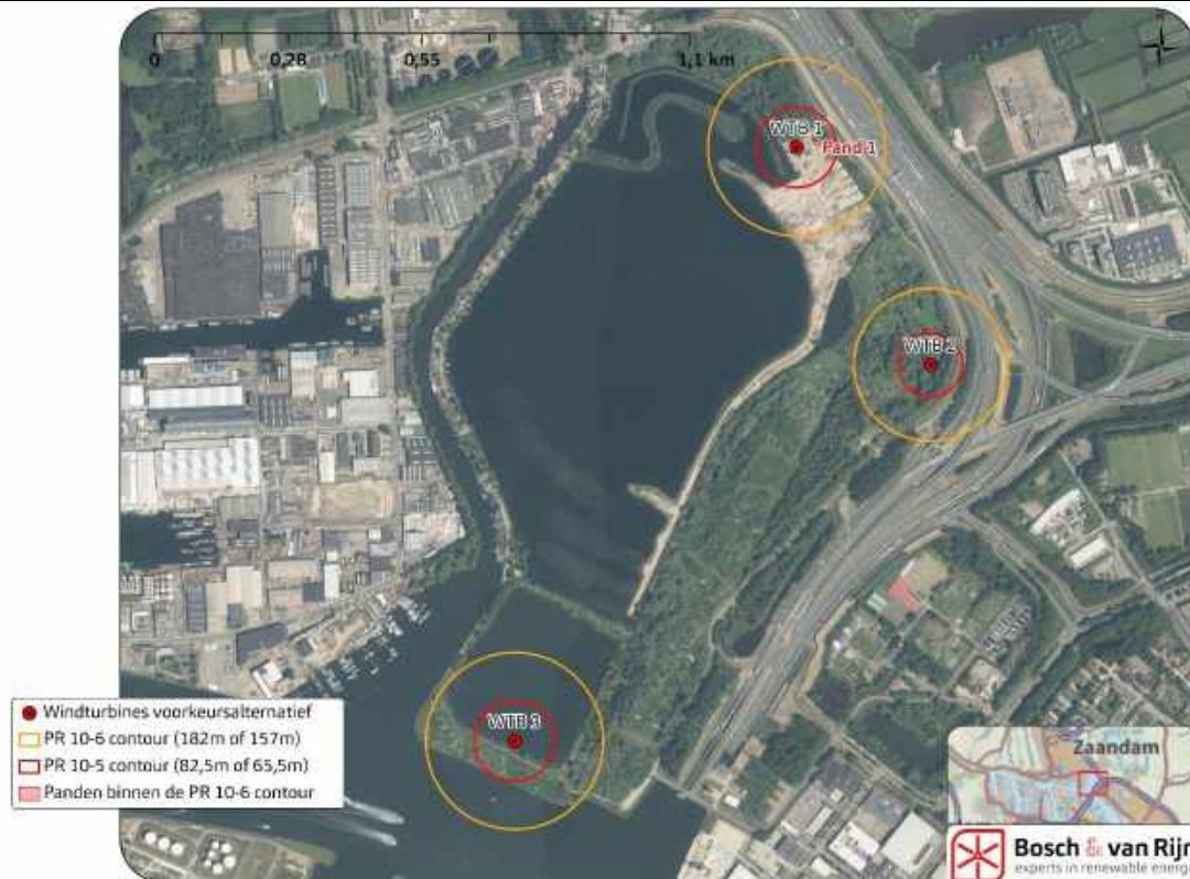
Figuur 10 Worst-case risicocontouren voor het Plaatsgebonden Risico rond windturbines
