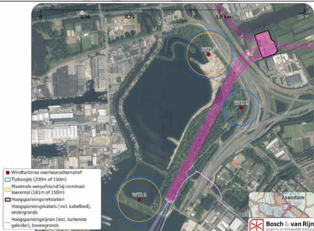
Figuur 11 Hoogspanningsinfrastructuur TenneT (voor Wt 2 vallen tiphoogte en werpafstand bij nominaal toerental samen waardoor maar 1 contour zichtbaar is)
